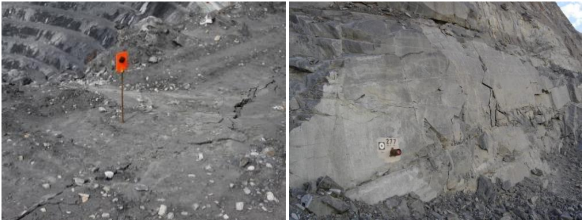
Рисунок 3.6 - Пример установки стационарных отражательных призм
