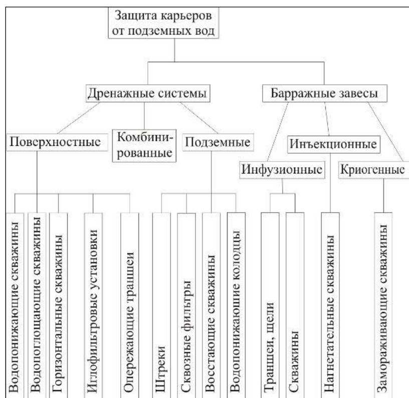
Рисунок 4.17 – Схема классификации способов защиты карьера от подземных вод
